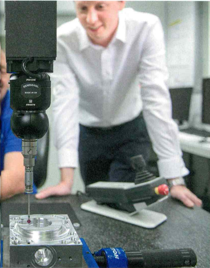
3D-Kontrolle: Mit der Koordinatenmessmaschine lassen sich Bauteile mit höchster Präzision überprüfen.
