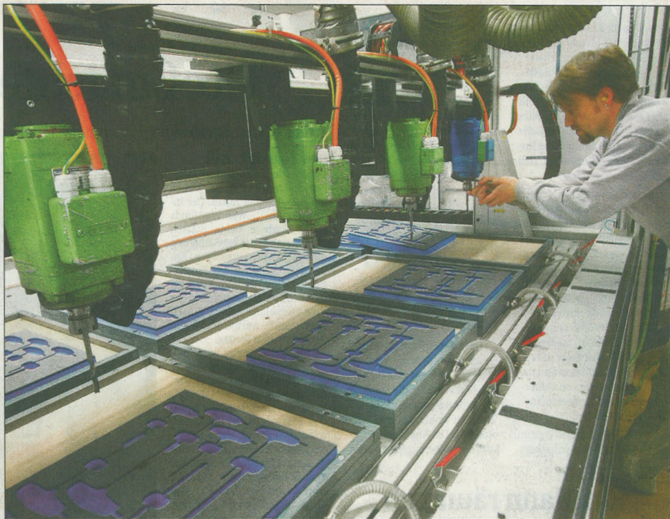
Maschinenführer Andrzej Mzyk bearbeitet Schaumstoff mit einer computergesteuerten Fräse.
